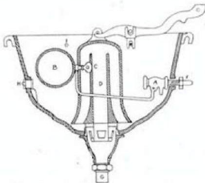
Coupe du réservoir n° 1031 monté avec robinet flotteur ordinaire.
