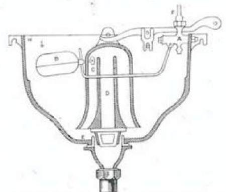
Coupe du réservoir n° 1032 monté avec robinet flotteur à ressort pour fortes pressions.
