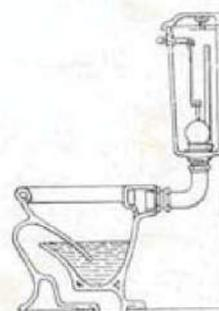
Ce genre d'installation est recommandé pour Grands Hôtels et Etablissements de Luxe. Le fonctionnement du réservoir s'effectue sans aucun bruit et la chasse complète s'obtient sans avoir recours à une seconde manipulation du réservoir.
